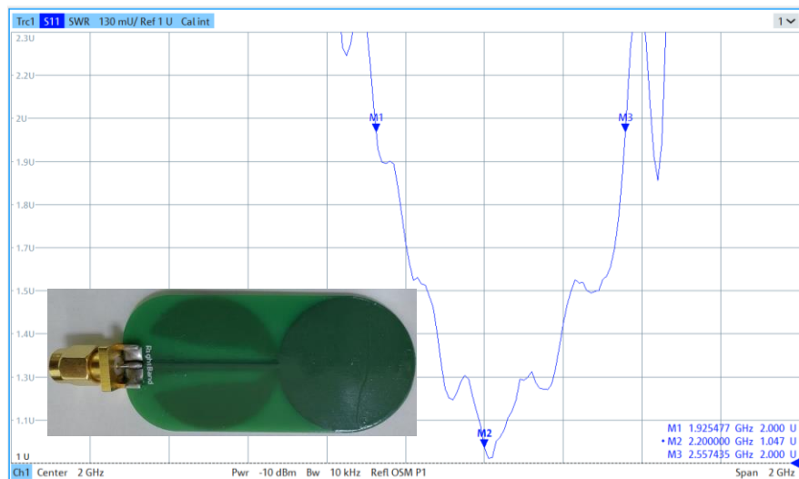
Частотный диапазон: 2100–2400 МГц [11] КСВн ≤ 2,2 | Длина = 65 мм | Вес = 10 г
